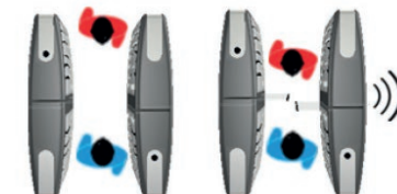
Al intentar pasar del lado incorrecto la alerta se activa
